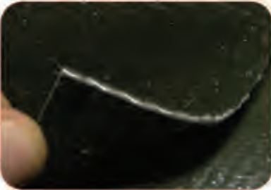
Cam Elyaf Kumaşlar Hypalon Kaplı (180°c)
